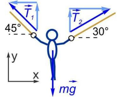
Les composantes  $x$  et  $y$  des tensions doivent être exprimées en fonction des angles (posons  $\theta_1 = 45^\circ$  et  $\theta_2 = 30^\circ$ ). Aussi, on tiendra compte du sens des axes pour attribuer un signe à chaque terme, puisque les angles ne sont pas définis par rapport à une direction unique :
