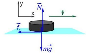
L'équation (1) sera utilisée pour calculer le module ( $f$ ) de la force de frottement, mais il faut d'abord évaluer l'accélération à partir du traitement de la cinématique. En posant que la distance fournie amène la rondelle de  $x_0 = 0$  à  $x = 28,2 \text{ m}$ , et sachant que la vitesse finale est nulle :
