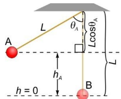
La hauteur  $h_A$  demande une analyse géométrique du montage. Par rapport au point le plus bas, la hauteur  $h_A$  est la différence entre la longueur du fil ( $L$ ) et le côté vertical du triangle illustré sur la figure ci-haut, dont la grandeur est  $L \cdot \cos\theta_A$ . On peut alors calculer la vitesse de la masse :
